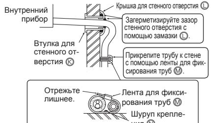
После проверки на отсутствие утечек плотно нанесите изоляционный материал, чтобы обеспечить отсутствие зазоров.
