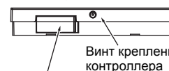
Винт крепления крышки контроллера Гнездо для карты памяти SD (для обновления программного обеспечения)
