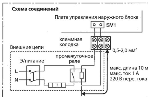
На выход SV1 печатного узла подается напряжение (220 В перем. тока) на период 15 минут после включения режима оттаивания наружного теплообменника.
