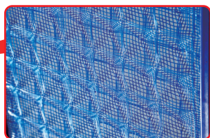
объемная структура фильтра (3D)
