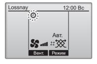
Обудет отображаться в главном окне, когда включена функция «Таймер автоотключения».
