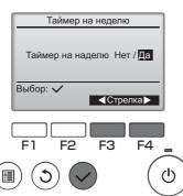
Отобразится окно для включения (Да) или отключения (Нет) таймера на неделю.
