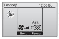
Когда отображается в главном окне, система находится под централизованным управлением и значок очистки не может быть сброшен.
