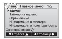
Следующие настройки не могут быть выполнены со вспомогательного контроллера. При необходимости, выполните эти настройки с основного контроллера. «Глав.» будет отображаться в заголовке главного меню на основном контроллере.
