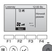
Нажмите кнопку <u>ВКЛ/ВЫКЛ</u> при работе в Ночной режим.
