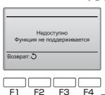
Слева отобразится сообщение, если пользователь выбрал функцию, которая не поддерживается моделью соответствующего блока Lossnay.
