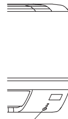
Переключатель аварийного управления (E.O. SW)
