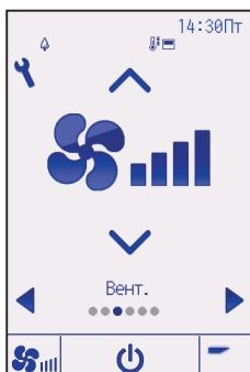
При каждом нажатии кнопки ▼ или ▲ осуществляется циклическая прокрутка следующих значений скорости вентилятора.
