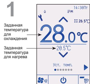
Отобразятся текущие значения температур. При каждом нажатии кнопки **◀** или **▶** будет переключаться заданная температура для охлаждения и нагрева.
