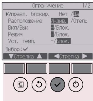
Отобразится окно, в котором можно настроить функцию блокировки управления.
